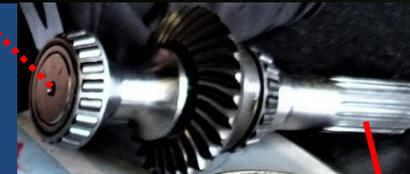
Il est impératif de marquer un point d'ARRET entre la marche AV et la marche AR ou revenir au PM si l'hélice est engagée dans un filet ou un bout ! ; si on ne respecte pas cela on provoque l'altération du Sail-drive et à terme sa destruction...
